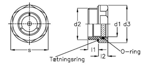
d1 = 18 d2 = G3/4 d3 = 32 l1 = 9 l2 = 8 Max pressure = -Max vacuum mbar = s = 30
